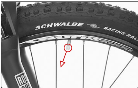
Ventil zeigt nicht zum Laufradmittelpunkt
